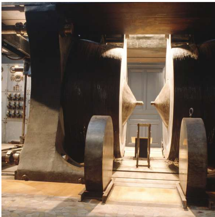
Inauguré en 1928 et d'une masse de 120 tonnes, cet électro-aimant est à l'époque le plus puissant du monde et préfigure les grands équipements nationaux du futur CNRS.
