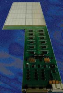
A gauche : calibration de 1/3 du prototype (3000 voies) sur banc cosmique – A droite : 1 ensemble PCB/Silicium
